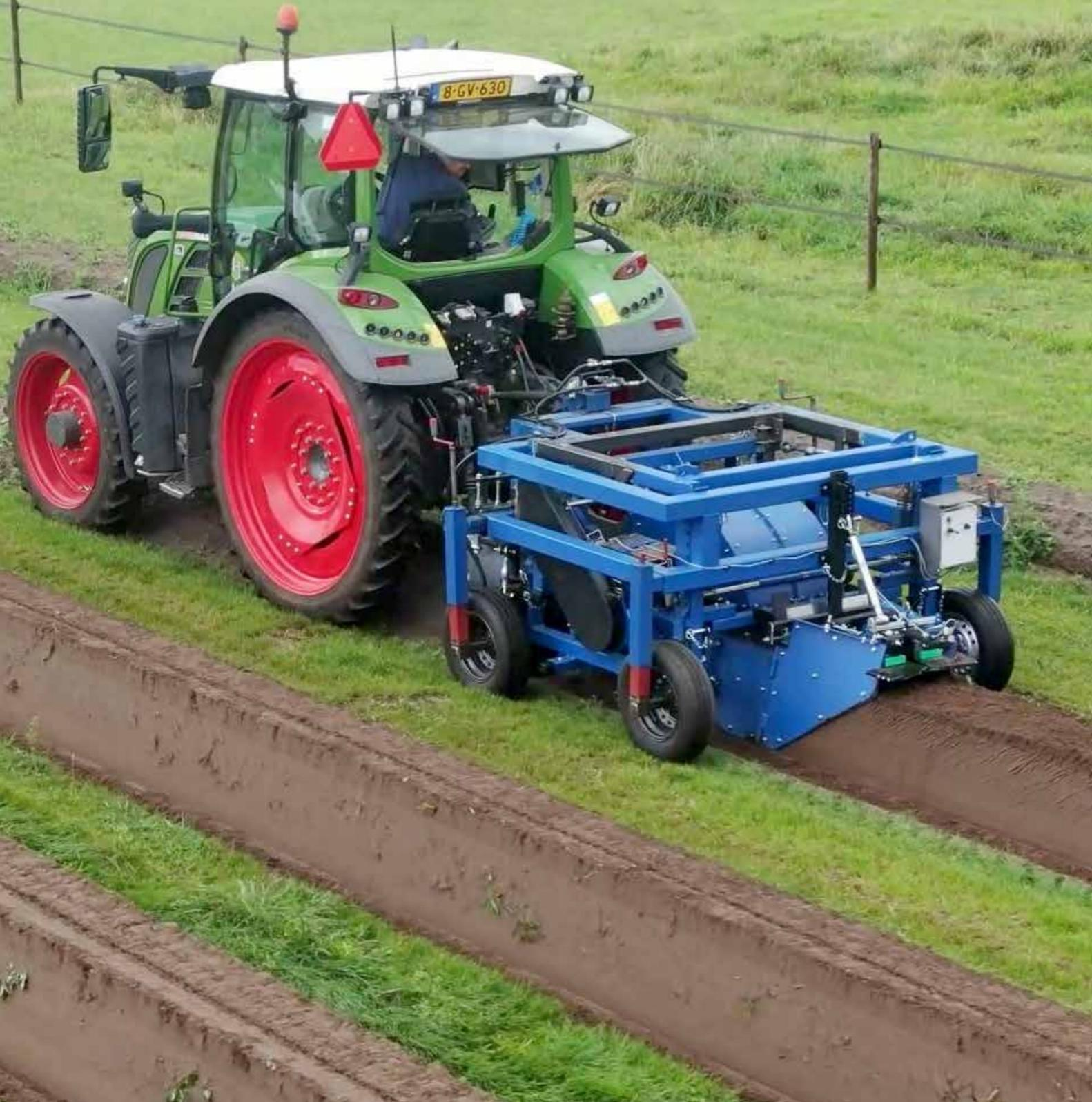
◀ *L'EcoSpader 2030 ne travaille le sol qu'entre le passage des roues du tracteur. La bande verte reste intacte pendant toute la durée de vie du champ d'asperges.*
